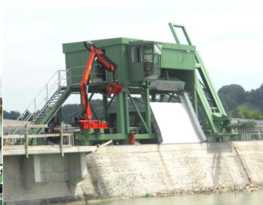
Fahrbare Seilrechenreinigungsmaschine mit Ladekran und Schwemmgutrechen
