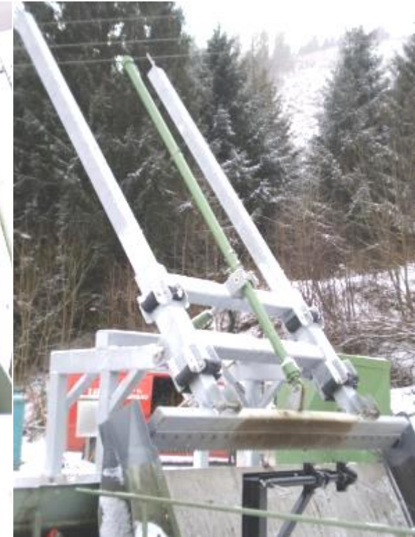
Teleskoprechenreiniger mit einer Harkenbreite von 4m
